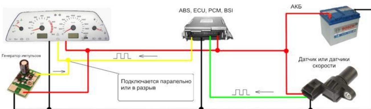
В версии устройства в корпусе разъёма прикуривателя, достаточно только подключить штекер в гнездо прикуривателя автомобиля. И далее провод с зажимом типа «крокодил» нужно соединить с сигнальным проводом скорости автомобиля. Найти положение автомобиля, где датчик скорости не блокирует сигнал.
