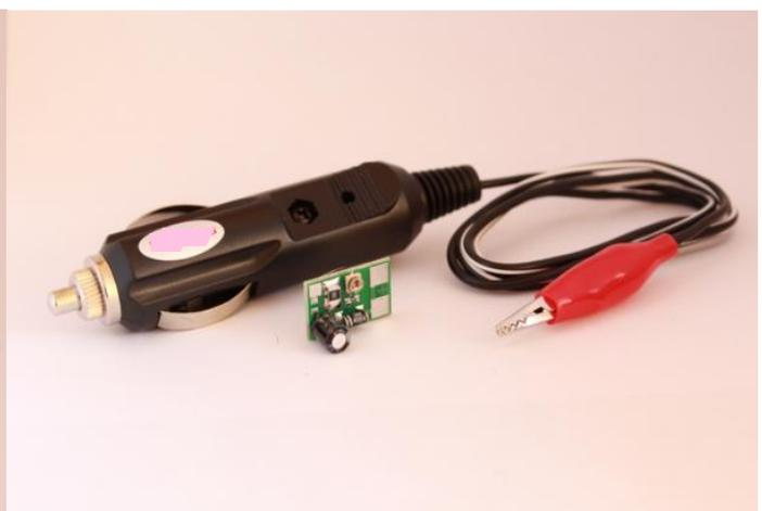
Генератор импульсов скорости.
