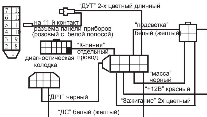
**СХЕМА ПОДКЛЮЧЕНИЯ (ВАРИАНТ Б)
