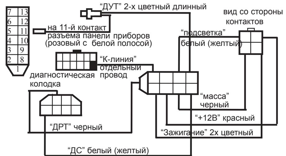
При установке БК на 83 "высокую" панель следует произвести подключение соответствующих проводов для получения сигналов с датчика уровня топлива, датчика скорости и датчика расхода топлива согласно существующей технической документации на электрооборудование автомобиля.
