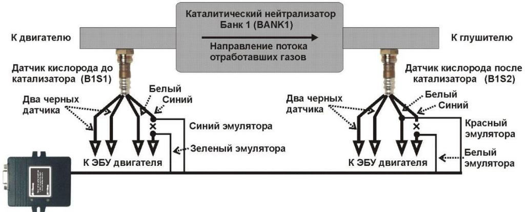
**ВНИМАНИЕ!!!** Расцветка проводов датчиков может отличаться от приведенной, для ее определения пользуйтесь приложением в конце инструкции.
