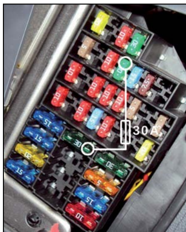
Рисунок 3. Схема подключения модуля МАКС-2 Largus к постоянному напряжению 12 В
