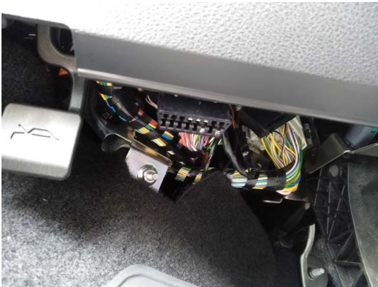
Фото 05 - найдите диагностическую колодку ОВД-II автомобиля, она находится слева, внизу, возле рычага открытия капота
