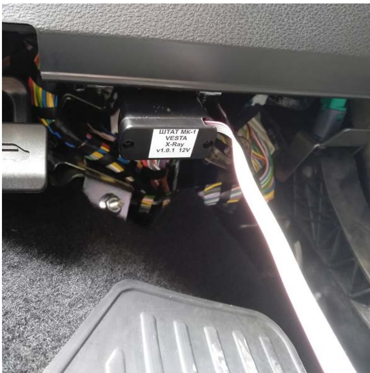
Фото 10 - подключите диагностический разъем МК-1 к диагностической колодке ОБД II автомобиля
