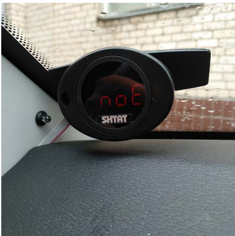
Фото 13 - отображение кодов ошибок в автомобиле, в данном случае ошибок нет, о чем и информирует это сообщение.
